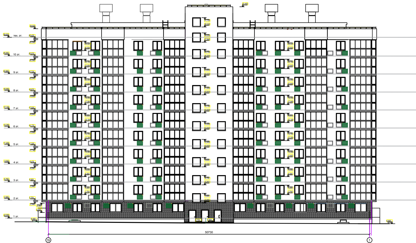
Схема размещения наружных блоков кондиционеров на фасаде "19-1".
